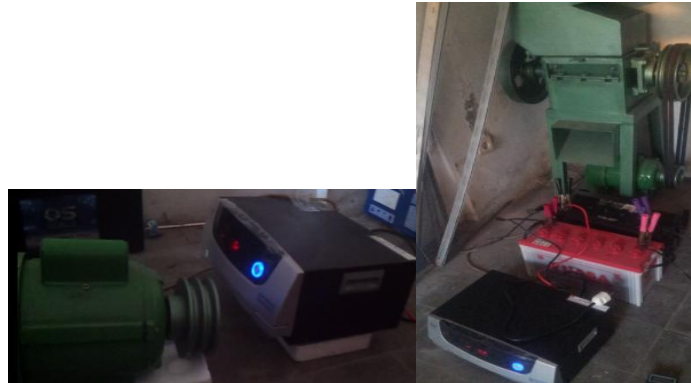
Gambar 7. Pengujian motor alat penghancur plastic
